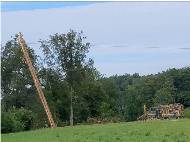
In Rudolfstetten setzten wir oberhalb der Kläranlage für den Holzschlag einen Seilkran ein, um die sehr feuchten Wiesen nicht zu schädigen und die Sicherheit vom Personal im schwierigen Gelände sicher zu stellen.
